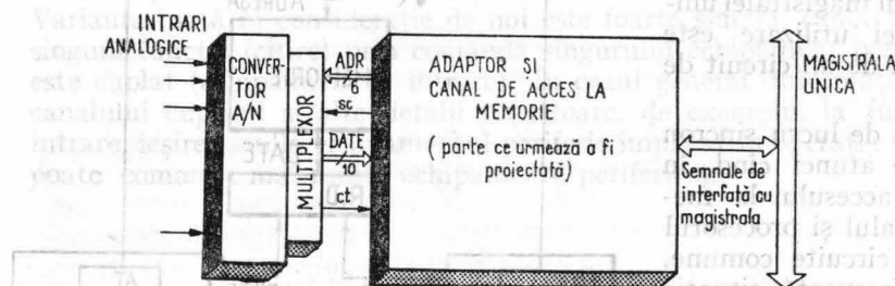
Fig. 2.30. Schema bloc a subsistemului de cuplare a unui convertor A/N la calculator.
